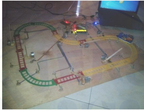
Gambar 4.7 saat kereta api dapat menutup palang pintu 3 otomatis
