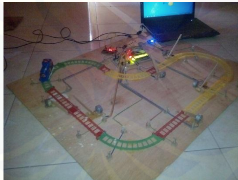
Gambar 4.3 saat kereta api dapat menutup palang pintu 1 otomatis
