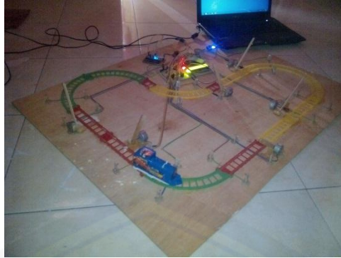
Gambar 4.4 saat kereta api dapat membuka palang 1 otomatis
