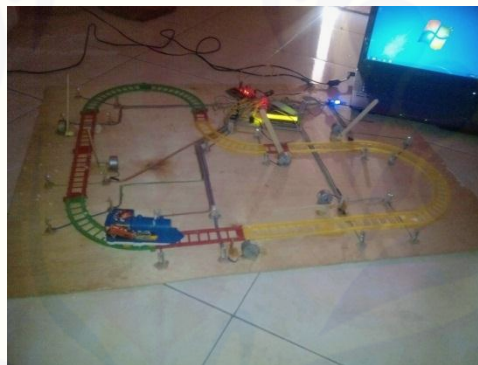
Gambar 4.5 saat kereta api dapat menutup palang 1 otomatis
