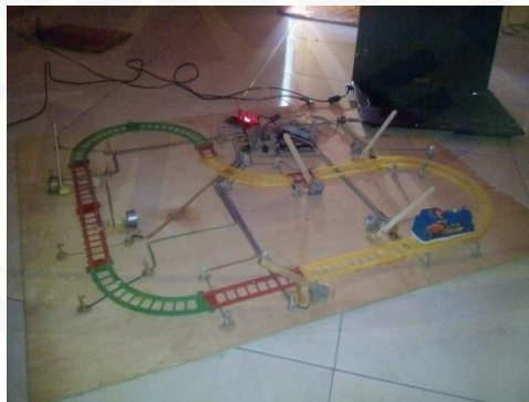
Gambar 4.6 saat kereta api dapat membuka palang 2 otomatis
