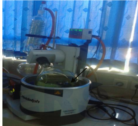
Gambar 3.2 Proses Evaporasi. Ekstrak yang sudah disaring dimasukkan ke dalam tabung, kemudian dilakukan evaporasi (penguapan) hingga diperoleh cairan pekat. (Sumber: Koleksi pribadi)
