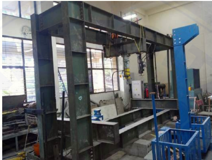
Gambar 2.23 Baja frame pengujian struktur (sumber: Krisnamukti, 2015)
