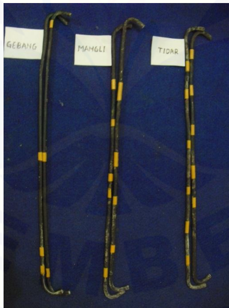
Gambar 4.1 Tingkat korosi baja tulangan
