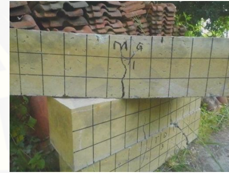
Gambar 4.12 pola retak balok MG 1
