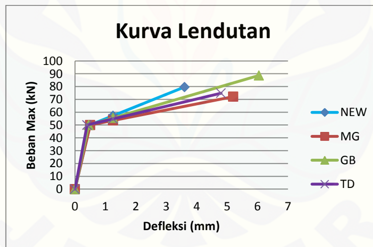
Gambar 4.21 Kurva hubungan beban – defleksi balok beton bertulang
