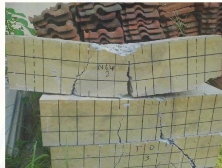
Gambar 4.10 pola retak balok NEW 2
