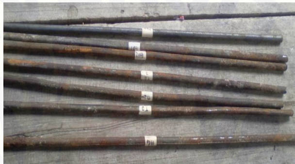
Gambar 4.2 Benda uji kuat tarik baja tulangan
