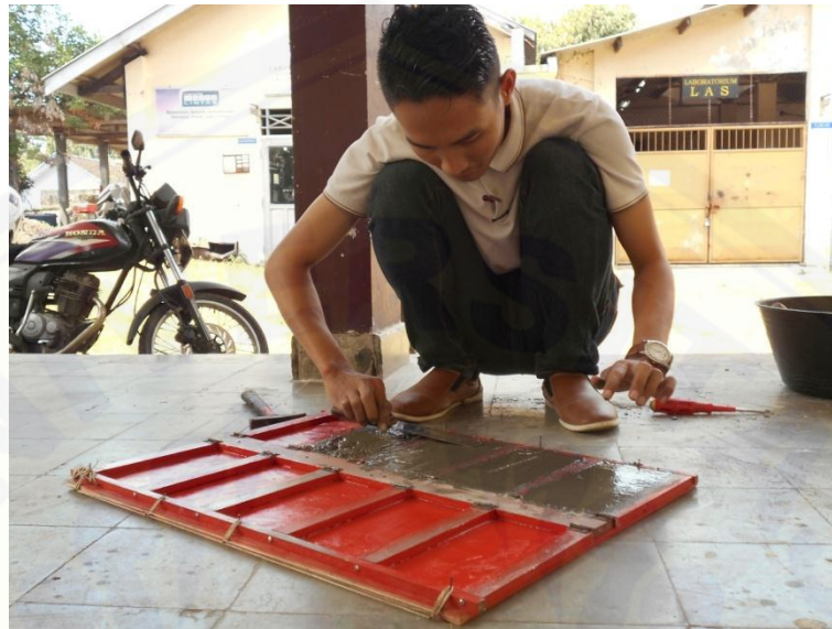
Gambar A 9. Pencetakan benda uji
