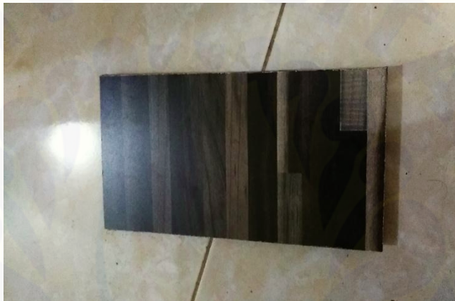
Gambar 4.5 Material wall/flooring dengan finishing HPL
