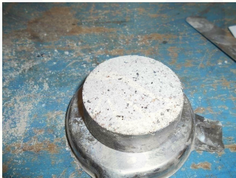
Gambar A 4. Pengujian berat volume kulit kopi
