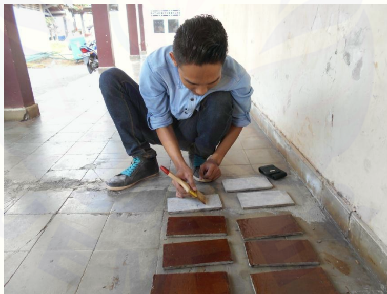
Gambar A 10. Proses finishing menggunakan movilex
