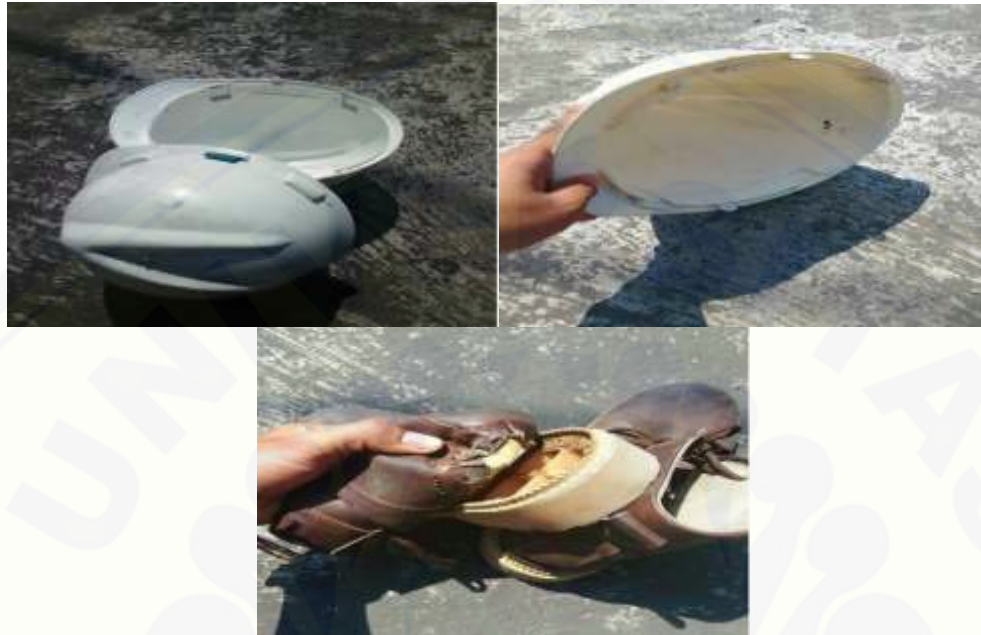
Gambar 4.3 Alat pelindung diri (APD) tidak layak pakai
