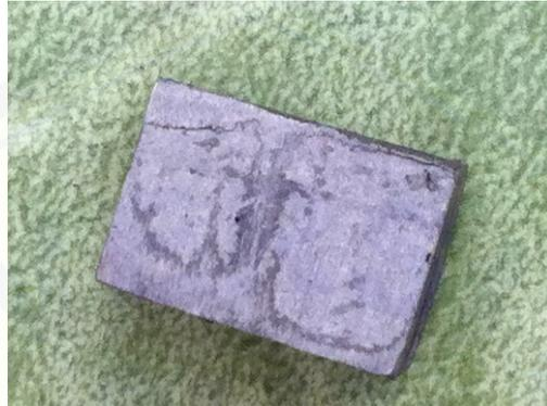
Gambar 4.9 Foto makro baja karbon AISI E 2512 setelah direndam ekstrak kulit buah manggis 1000 ppm selama 40 hari
