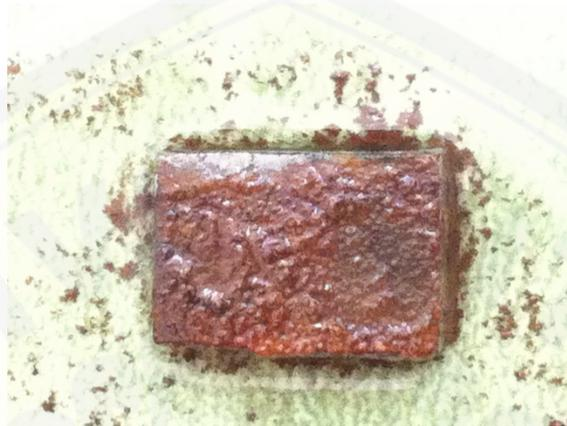
Gambar 4.8 Foto makro baja karbon AISI E 2512 setelah direndam ekstrak kulit buah manggis 0 ppm selama 40 hari
