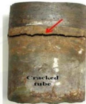
**Gambar 2.11** Korosi retak pada pipa (Arif, 2012)
