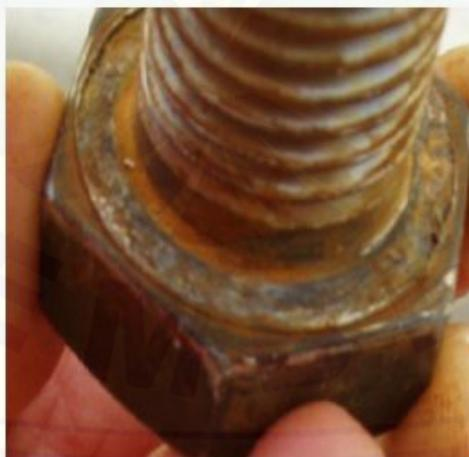
**Gambar 2.5** Crevice corrosion pada baut (Asdim, 2007)
