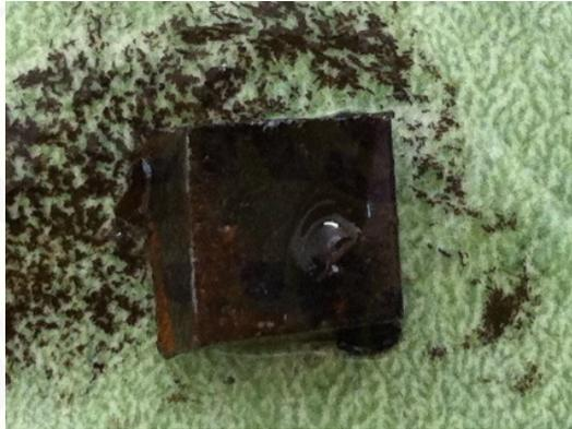
Gambar 4.11 Foto makro baja karbon AISI E 2512 setelah direndam ekstrak kulit buah manggis 1400ppm selama 40 hari
