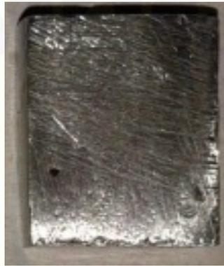
Gambar 4.7 Foto permukaan baja karbon AISI E 2512 sebelum dilakukan perendaman ekstrak kulit buah manggis.
