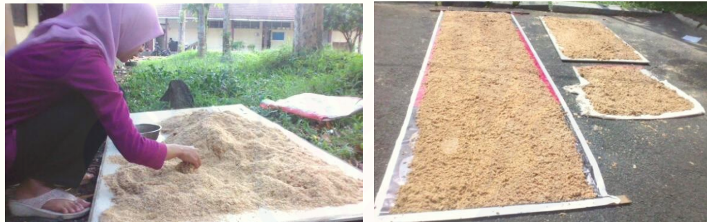
Gambar D.5 Pembersian dari kotoran dan penjemuran limbah serbuk gergaji kayu sengon
