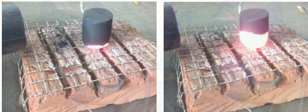
Gambar D.12 Pengujian waktu penyalaan dan waktu pembakaran briket
