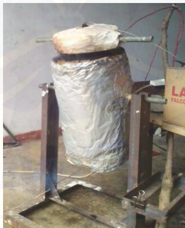
Gambar D.6 Proses pirolisis serbuk gergaji kayu sengon
