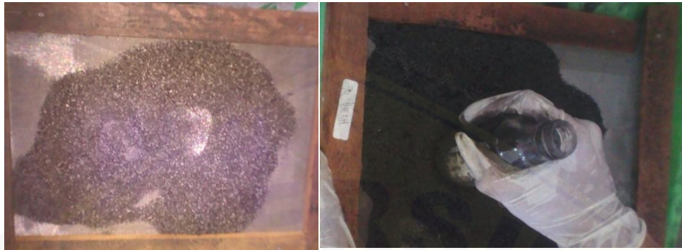
Gambar D.7 Proses pengayakan arang serbuk gergaji kayu sengon
