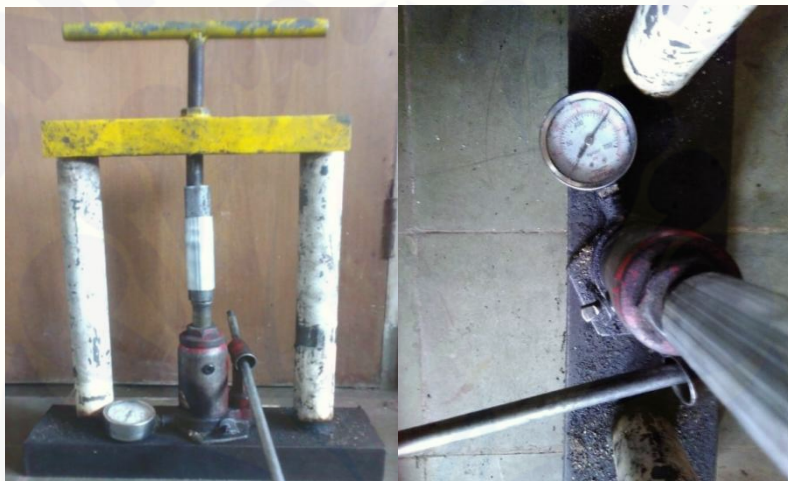
Gambar D.8 Proses pencetakan briket arang serbuk gergaji kayu sengon
