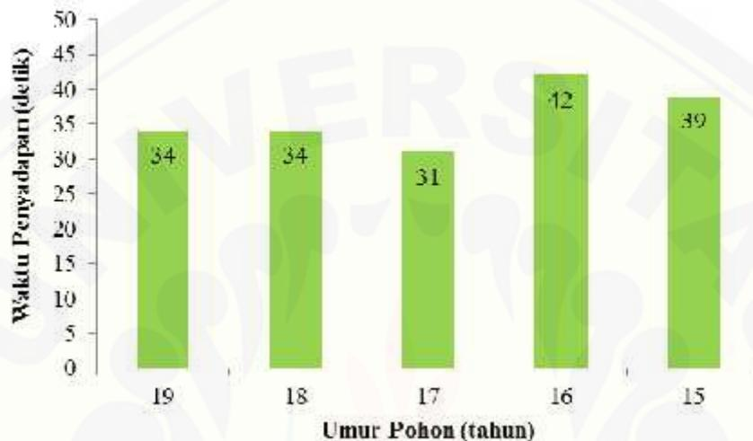
Gambar 4.10 Rata-rata waktu penyadapan menggunakan alat sadap karet semi mekanis dengan 4 mata pisau.
