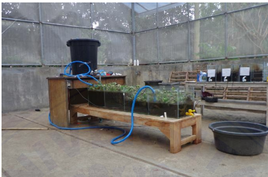
Gambar 4.2 Hasil Perancangan Akuarim Fitoremediasi Pengolah Limbah Cair Kopi dengan Sirkulasi (Sumber: Data Primer, 2015)
