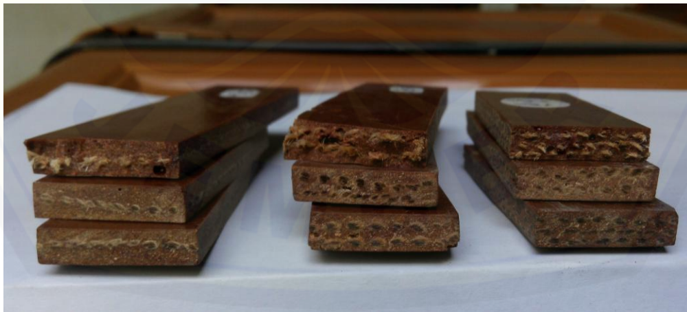
Gambar 4.12 Perbandingan Void Tiap Patahan 1 Lapis, 2 Lapis dan 3 Lapis
