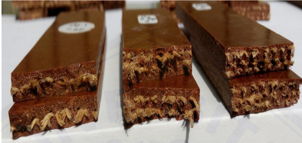
Gambar 4.2 Void Yang Terjadi Pada Spesimen
