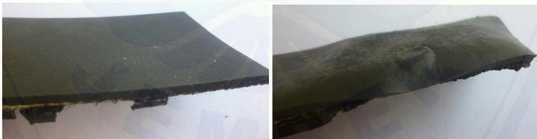
Gambar 4.8 Bentuk fisik karet *belt* setelah dilakukan proses pemanasan, (a) suhu pemanasan 130<sup>0</sup>C dan 150<sup>0</sup>C, (b) suhu pemanasan 170<sup>0</sup>C
