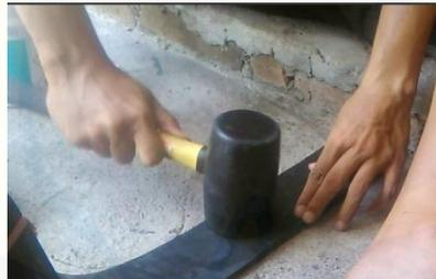
Gambar 3.23 Proses perekatan sambungan *belt* dengan palu karet
