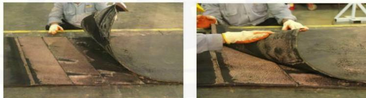
Gambar 3.18 Pengepasan sambungan *belt*
