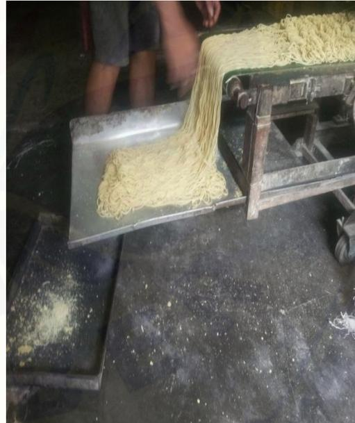
Gambar 4. Proses Pecetakan Mi
