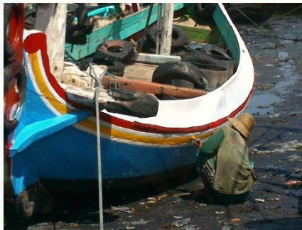
Gambar 4.16 Pengecatan Perahu (Sumber : Dokumentasi Pribadi)
