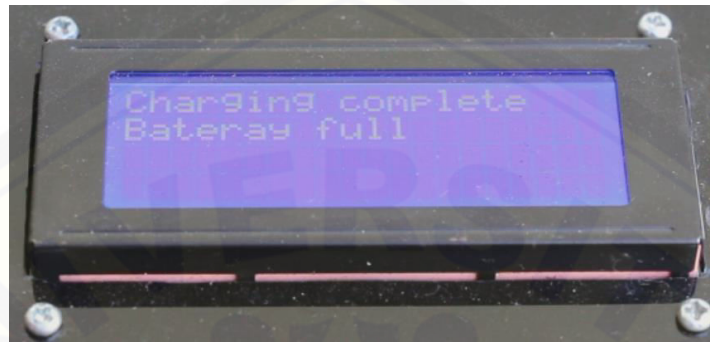
Gambar 4.13 Tampilan LCD ketika proses charging berhenti secara otomatis
