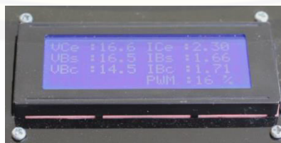
Gambar 3.17 Tampilan LCD 20 x 4 penampil
