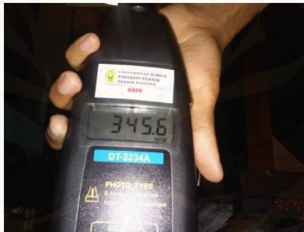
Gambar 4.4 Hasil Pengukuran Kecepatan Putar Tegangan 10 Volt DC
