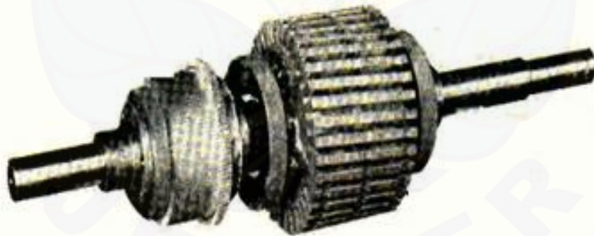
Gambar 2.14 Inti Jangkar dan Poros (Tonny, 2011)
