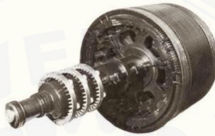
(a) Rotor Belitan Tampang Samping Kanan; (b) Rotor Belitan Tampang Samping Kiri Gambar 2.21 Tipe rotor belitan untuk motor induksi (Sumber: General Electric Company. )
