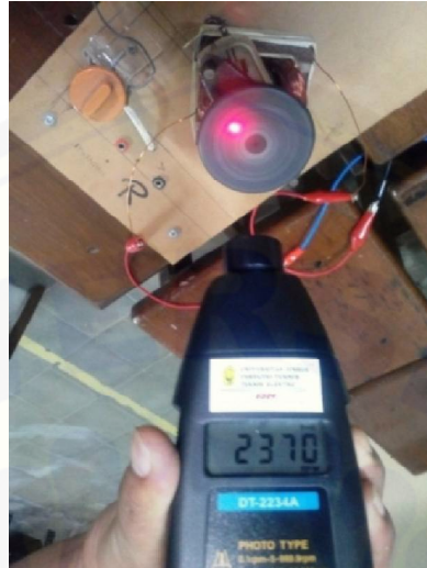
Gambar 4.2 Pengukuran Kecepatan Motor Tegangan AC 50 Volt
