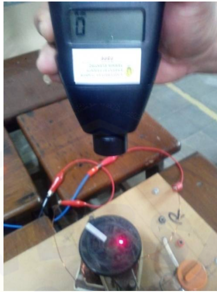
Gambar 4.1 Pengukuran Kecepatan Motor Tegangan AC 10 Volt
