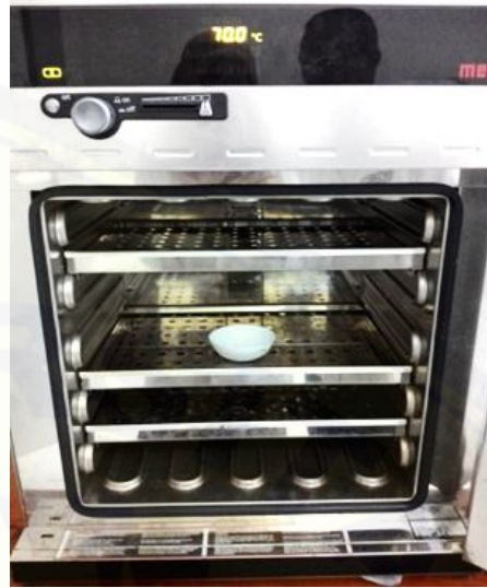
Proses pengeringan serbuk microspheres dengan oven
