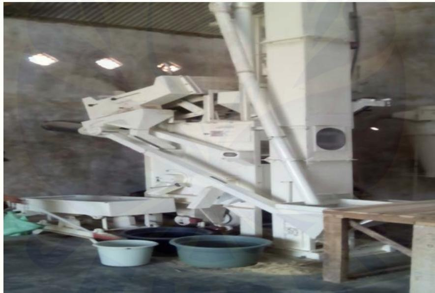
**Gambar 4. Mesin Penggiling Gabah yang Berkapasitas 3 ton milik *Rice Milling Unit Mandiri***
