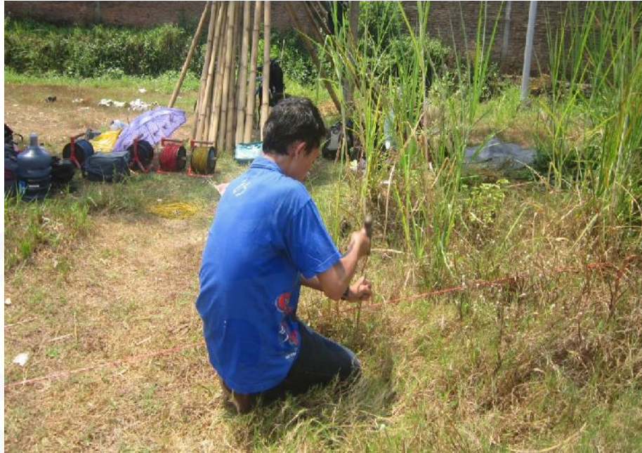
Gambar E.3 Penancapan elektroda
