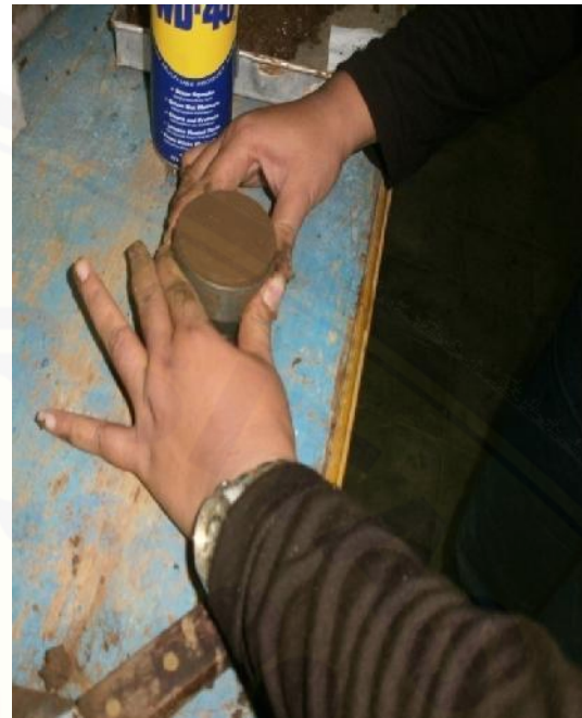
Gambar G.3 Sampel tanah dikeluarkan dari ring
