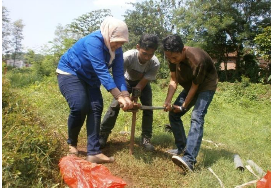
Gambar F.3 Pengangkatan tabung sampel tanah
