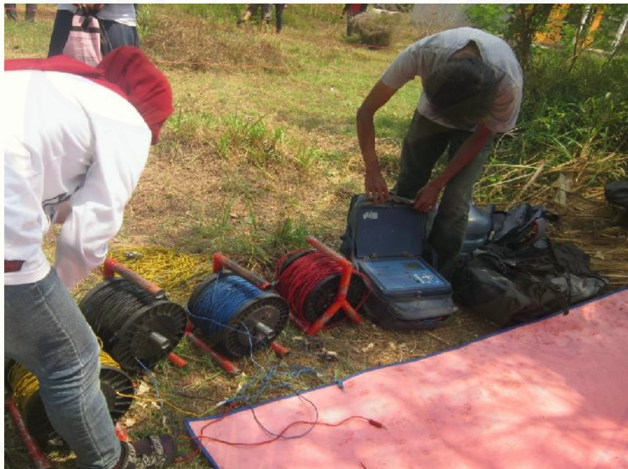
Gambar E.4 Persiapan alat geolistrik
