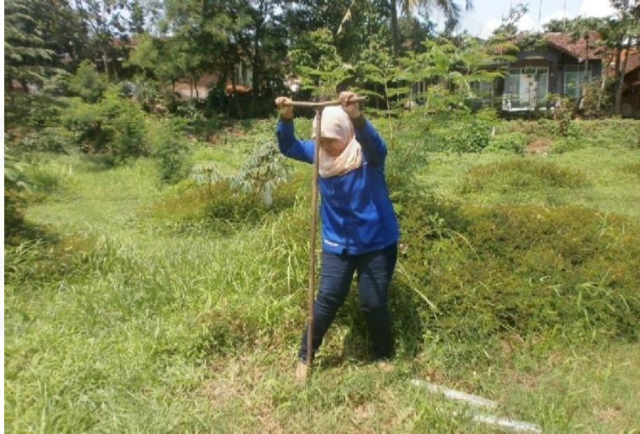
Gambar F.1 Pengambilan sampel tanah
