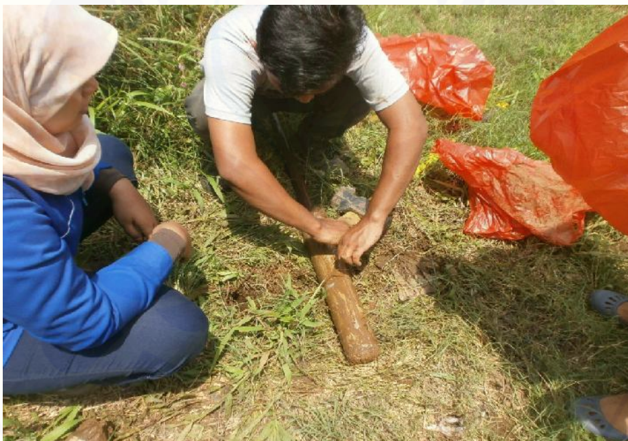
Gambar F.4 Tabung sampel tanah yang akan diuji di laboratorium
