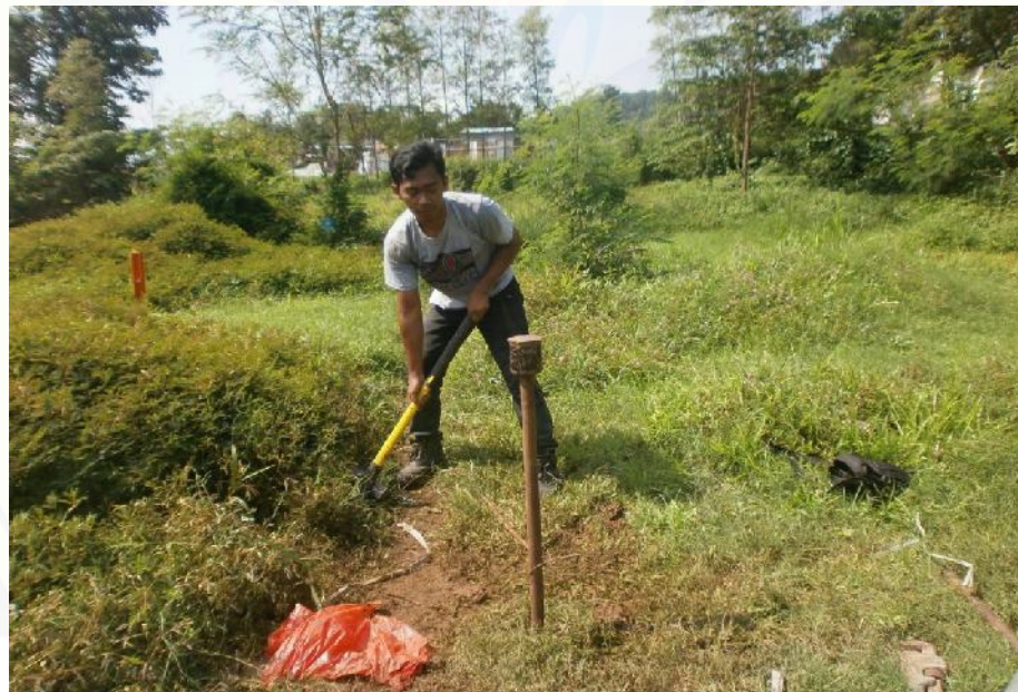
Gambar F.2 Pengambilan sampel tanah
