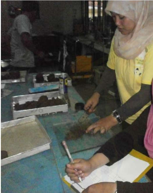
Gambar G.2 Pencetakan sampel tanah
