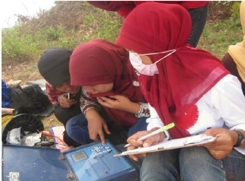
Gambar E.5 Pengambilan data geolistrik
