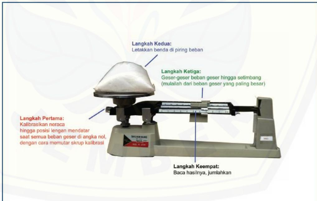
Massa suatu benda dapat diukur dengan menggunakan neraca lengan (gambar 1), sedangkan berat dapat di ukur dengan neraca pegas (gambar 2), neraca pegas dan neraca lengan termasuk dalam jenis neraca mekanik.
