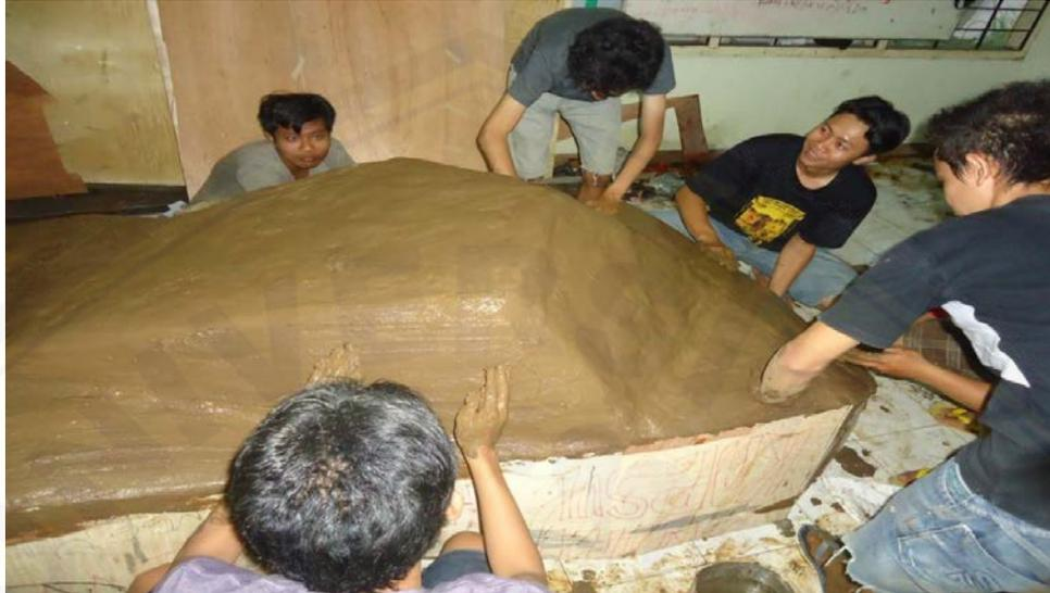
Gambar 4.10 Menempelkan tanah liat pada dinding rangka bodi
