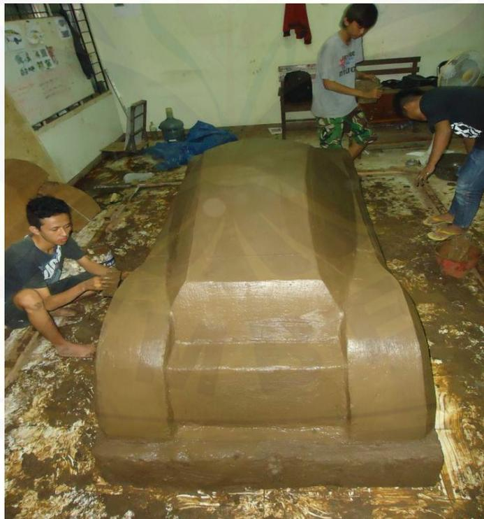
Gambar 4.11 Bentuk cetakan bodi tanah liat tampak belakang
