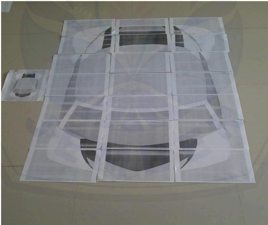
Gambar 4.8 Pembuatan sket/mal bodi mobil
