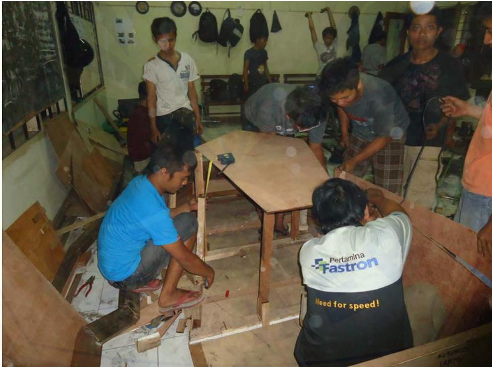
Gambar 4.6 Proses pemotongan dan penempelan triplek
