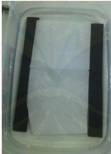
Gambar 4.2 Pencelupan larutan polimer ke dalam bak koagulasi
