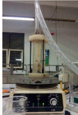
Gambar 4.4 proses fluks dengan sel ultrafiltrasi
