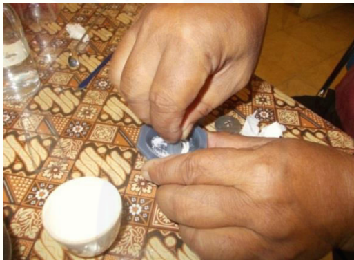
Pencampuran sampel dan bubuk KBr dengan menggunakan mortar dan pastel FTIR
