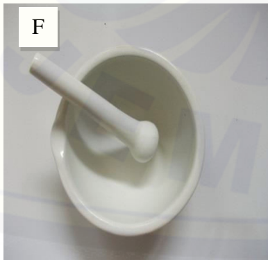
F. Mortar dan Pastel
