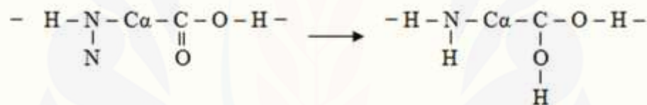
Gambar 4.2 Reaksi antara kation ( H^+ ) dengan ikatan rangkap C dan O Rantai Poliamida (Sumber: Mayasari, 2013)
