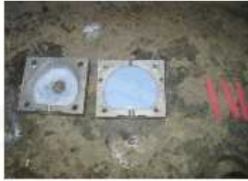
Gambar 3.2 Penempatan Gips dalam Kuvet (Sumber: Dokumen Pribadi, 2015)
