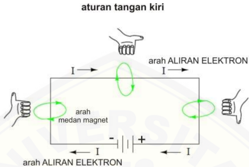
Gambar 2.2 Ilustrasi aturan tangan pada aliran magnet
