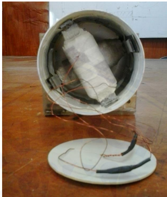
Gambar 4.2 Penyusunan letak lilitan kumparan
