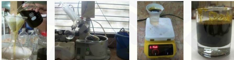
Gambar J.3 Ampas dan filtrat rendaman dipisahkan menggunakan kertas saring kimia sampai diperoleh ekstrak cair daun tembakau, kemudian diuapkan menggunakan rotary evaporator dengan suhu 50° C sampai diperoleh ekstrak kental. Ekstrak kental dituang dalam cawan porselen dan diuapkan lagi menggunakan water bath kemudian diangin-anginkan pada suhu kamar dan akhirnya proses ekstraksi selesai.
