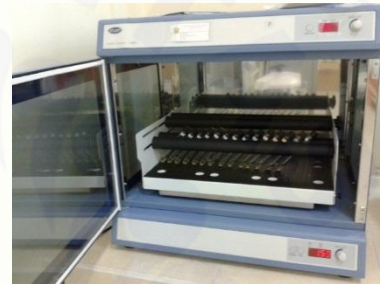
Inkubasi uji aktivitas antibakteri di dalam shaker incubator
