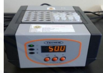
Hidrolisis enzimatis menggunakan dry block heater
