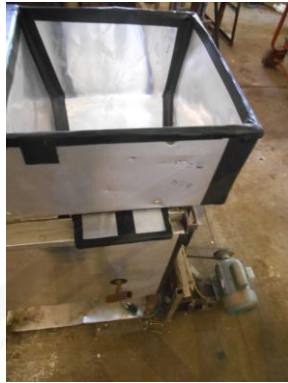
Hopper, Pengatur masukan bahan, Tuas pengatur kerapatan celah roll
