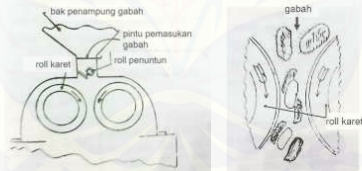
Gambar 2.2 Mekanisme pengupasan pada double roll
