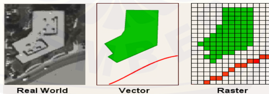
Gambar 3.3 Penampakan Citra Satelit Permukaan Bumi, Data Vektor dan Data Raster (Sumber : http://www.geography.hunter.cuny.edu ,2014)
