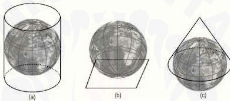
Gambar 2.5. Perbedaan Proyeksi (a) Cylindrical , (b) Planar dan (c) Conical
