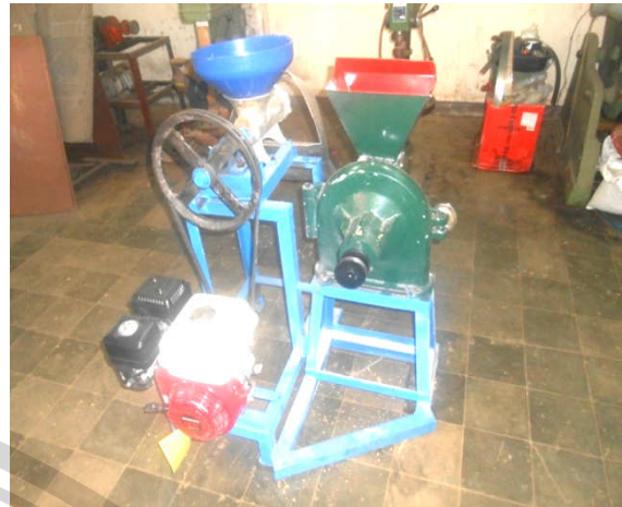
Gambar 1. Alat penepung dan pencetak pelet ikan
