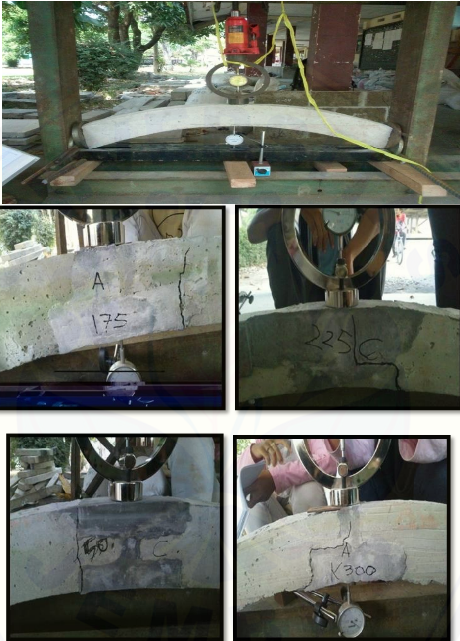
Gambar 4.5 Keruntuhan Beton Lengkung Sambungan
