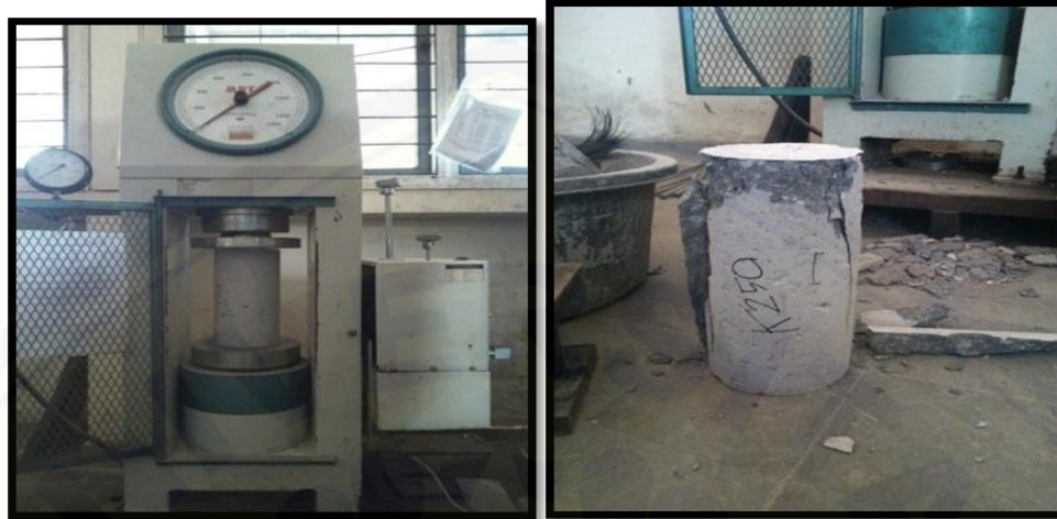
Gambar 4.1 Pengujian Kuat Tekan Beton Silinder
