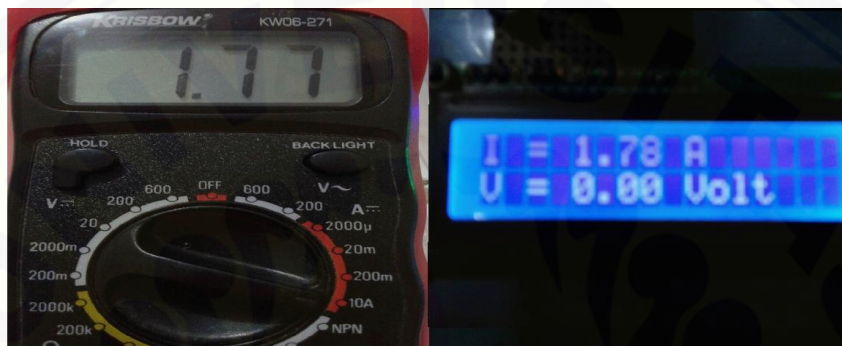
Gambar 4.3 Pengujian sensor arus dengan beban 35 Watt
