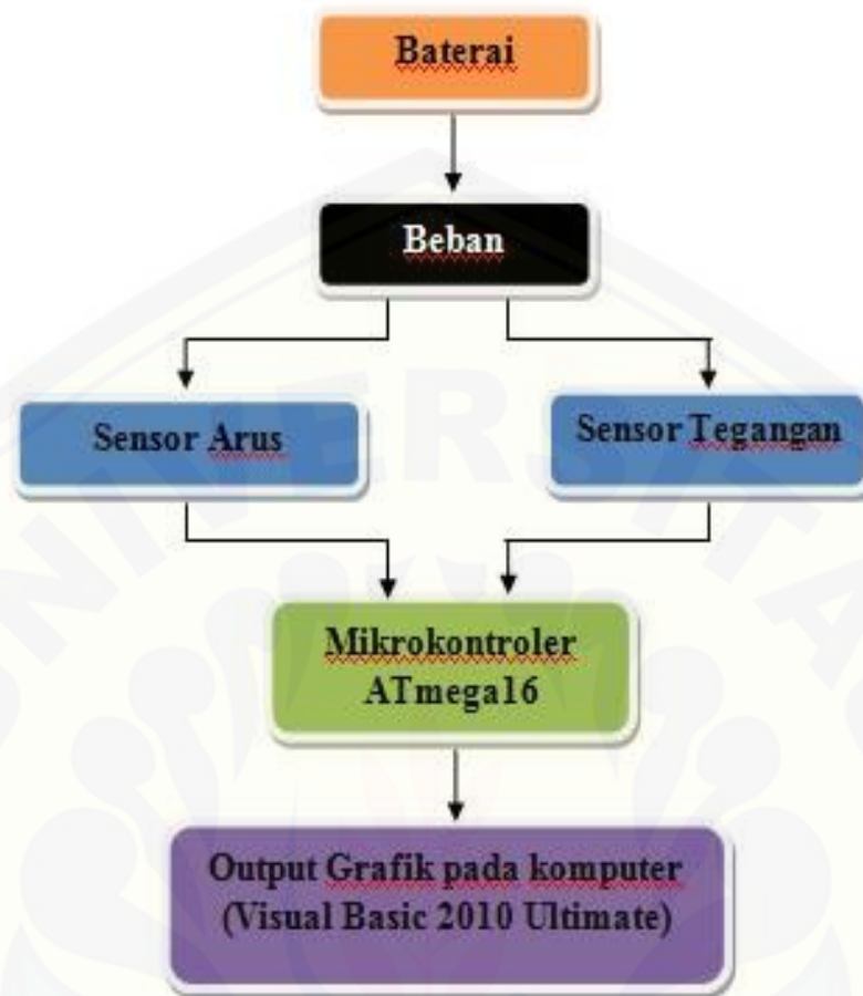
Gambar 3.1 Diagram Blok Sistem Monitoring Arus dan Tegangan Pada Baterai Mobil Listrik Berbasis ATmega16
