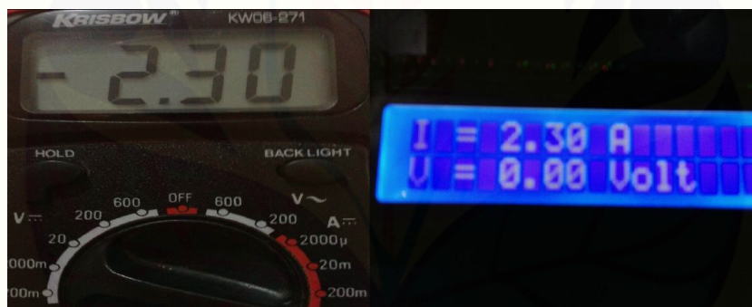
Gambar 4.4 Pengujian sensor arus dengan beban 43 Watt
