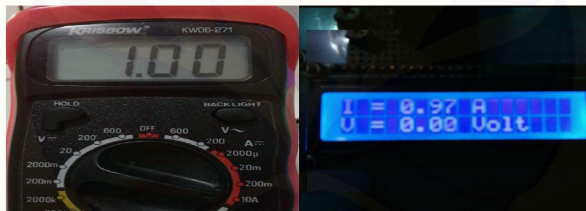
Gambar 4.1 Pengujian sensor arus dengan beban 18 Wat
