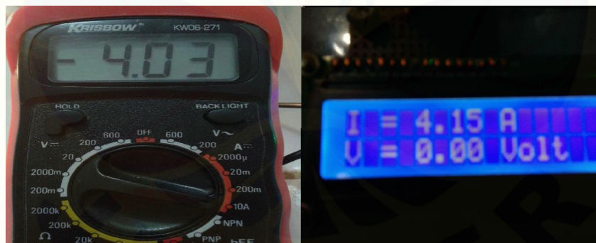
Gambar 4.7 Pengujian sensor arus dengan beban 78 Watt
