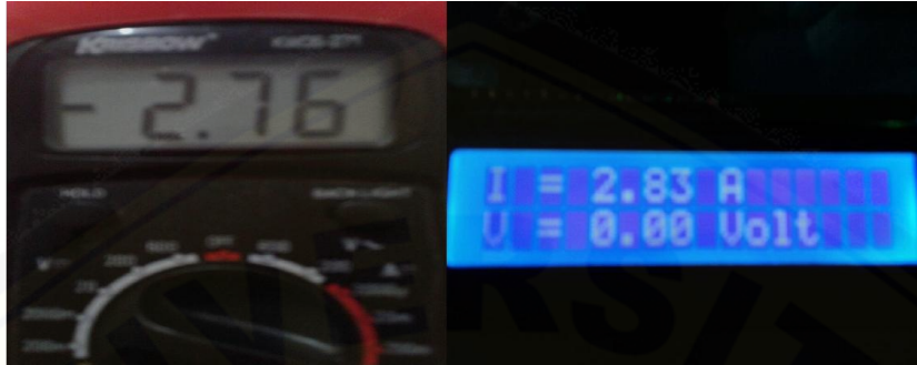
Gambar 4.5 Pengujian sensor arus dengan beban 53 Watt
