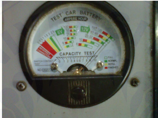
Gambar 4.20 Kondisi baterai penuh pada alat Test Car Battery
