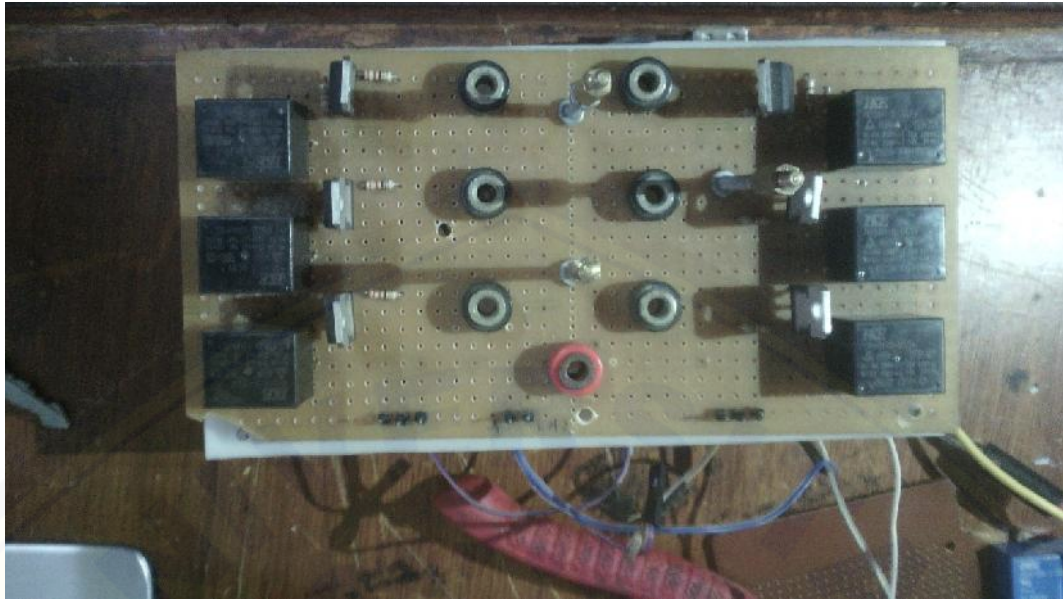
Gambar 3.13 Rangkaian Kontrol Relay Dengan masukan Dari GPIO Raspberry Pi
