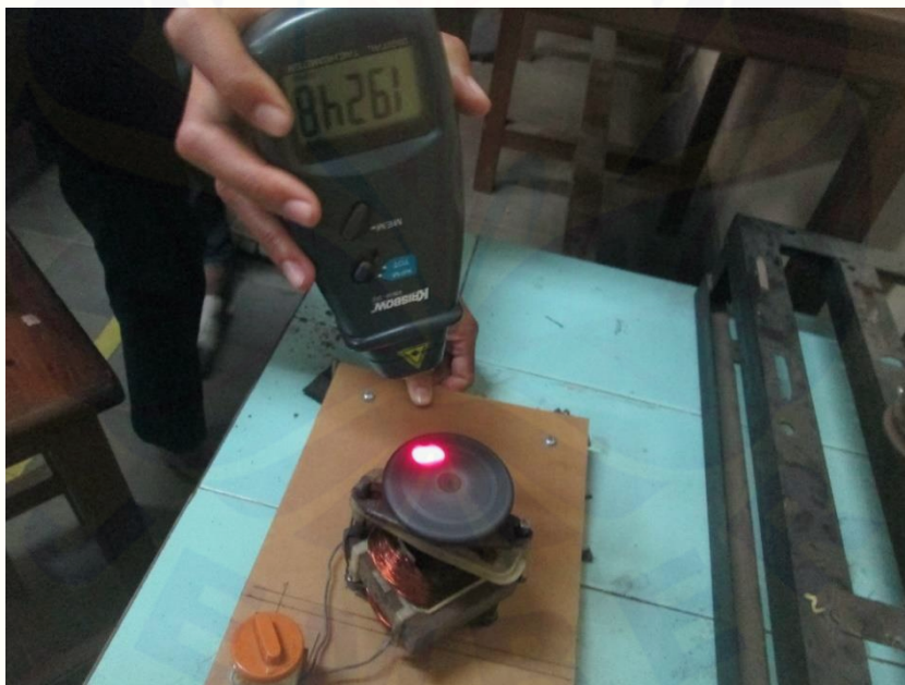
Pengukuran kecepatan rotor (rpm) motor rewinding pada tegangan 220 V
