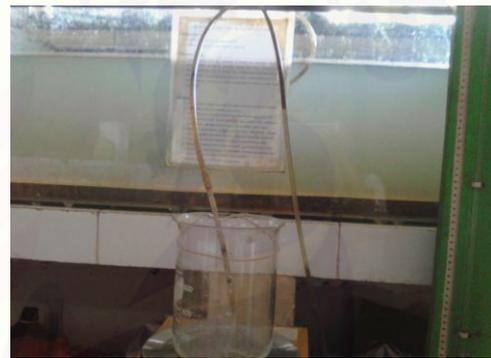
Gambar 3.2 Perendaman ring sampel untuk pengukuran konduktivitas hidrolik dan pengukuran konduktivitas hidrolik
