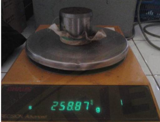
Gambar 3.1 Ring sampel berisi tanah untuk pengukuran berat volume
