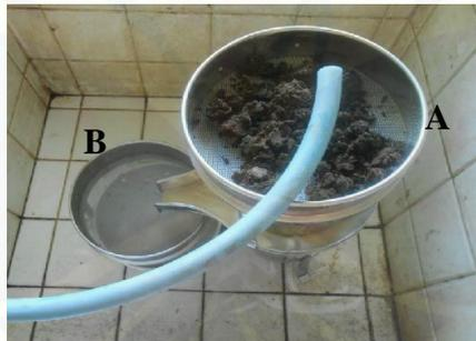
Gambar 3.2 Fenwick (Alat untuk ekstraksi tanah dan pengumpulan sista)
