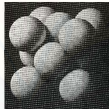
Gambar 2.2 Struktur kristal FCC untuk gas mulia (Ne, Ar, Kr, Xe) (Sumber: Kittel, 2005)
