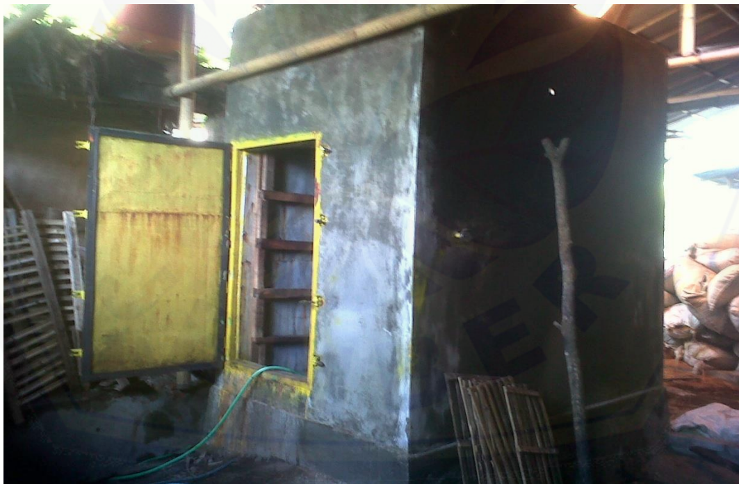
Gambar 2. Steamer/tempat mensterilkan baglog sebelum ditanami bibit F2
