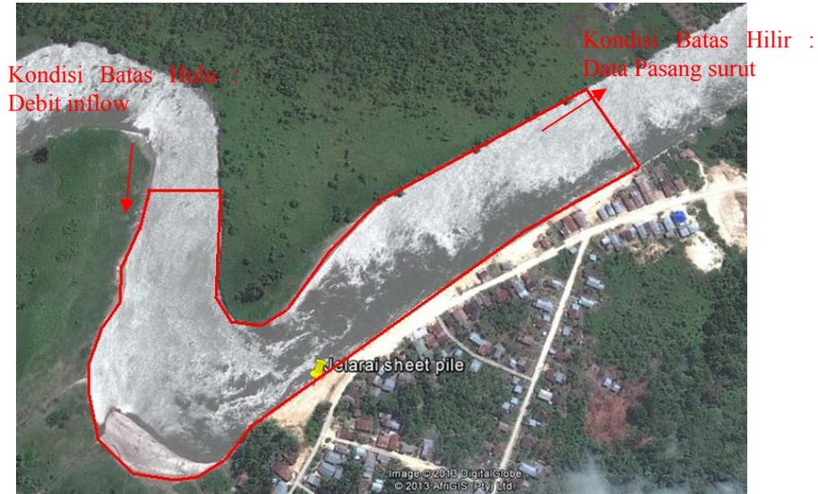
Gambar 6. Skematis pemodelan dan kondisi batas yang digunakan untuk Sungai Jelarai yang dioverlay-kan pada foto udara (Google Earth, 2014).
