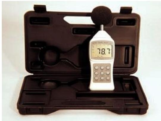
Gambar 3.3 Peralatan *Sound Level Meter*
