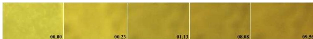
Gambar 4.12 Foto hasil mikroskop kamera tes strip feri amonium sulfat dengan sampel piroksikam
