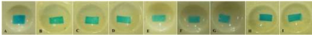
Gambar 4.15 Limit deteksi tes strip kobalt tiosianat+piroksikam A)tanpa sampel, B)5mg/ml, C)4mg/ml, D)3mg/ml, E)2mg/ml, F)1mg/ml, G)0,5mg/ml, H)0,25mg/ml, I)0,125mg/ml
