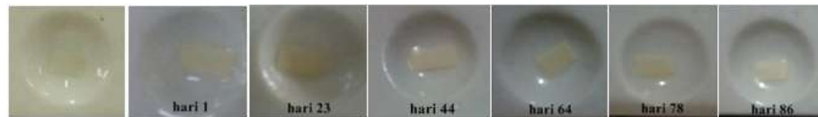
Gambar 4.28 Life time tes strip feri amonium sulfat dengan sampel fenilbutazon
