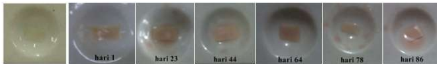
Gambar 4.27 Life time tes strip feri amonium sulfat dengan sampel piroksikam
