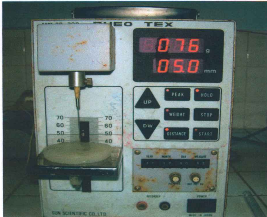
Gambar 9. Alat mengukur tekstur, rheo tex
