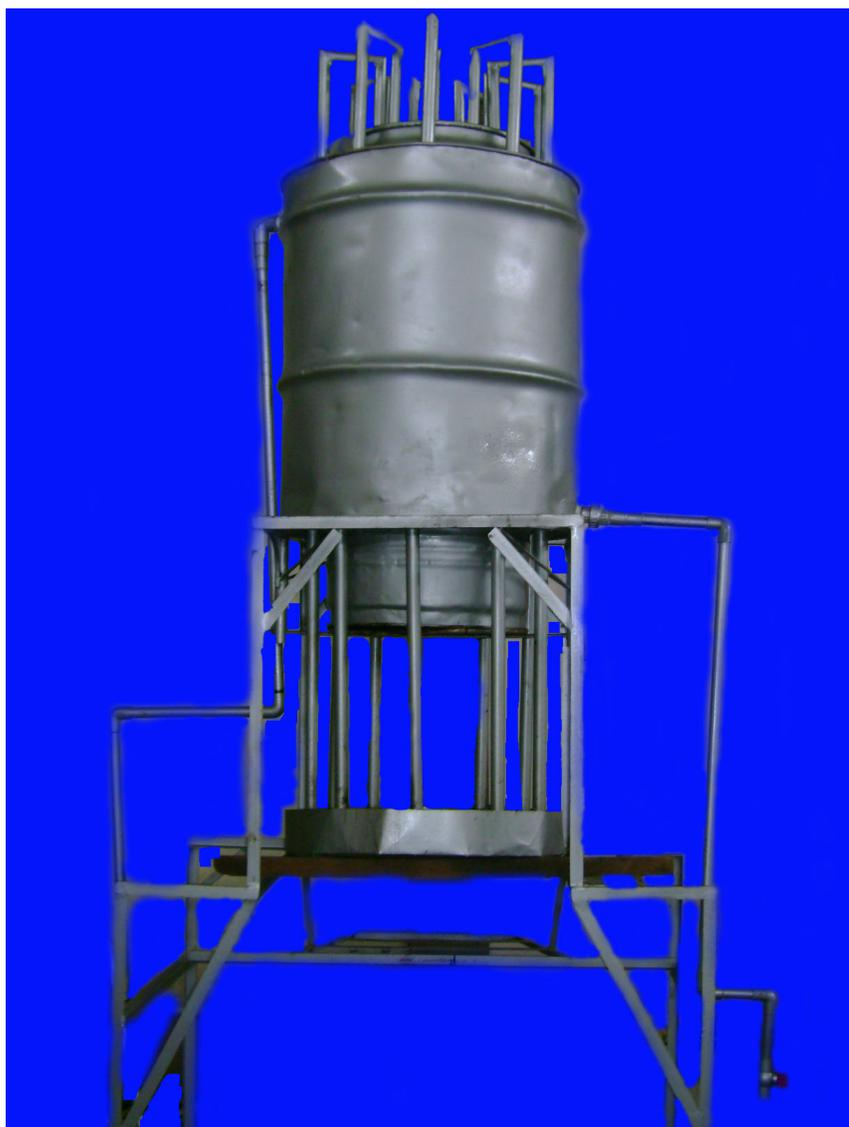
**Gambar 4.6 Mesin Pirolisator**
