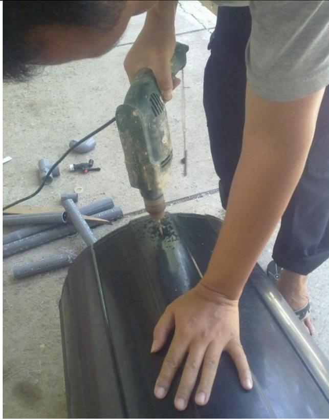
Gambar 15. Pembuatan lubang output kran pada tong plastic
