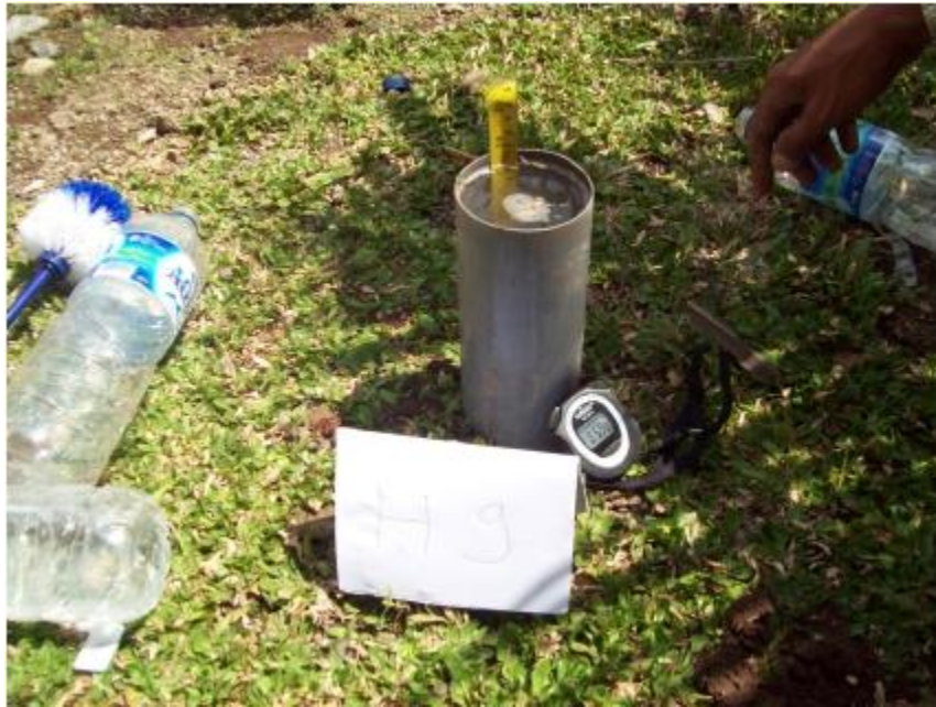
Gambar 3. Test Permeabilitas Tanah Di Salah Satu Percontohan Sumur Resapan
