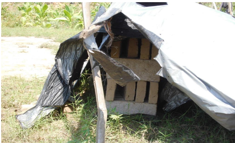
Proses Pengeringan batu bata sebelum dibakar
