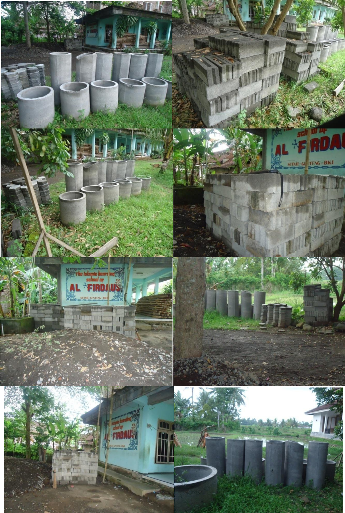
Gambar 11. Hasil Produksi Beton Pracetak (Paving, Batako dan Gorong-Gorong)
