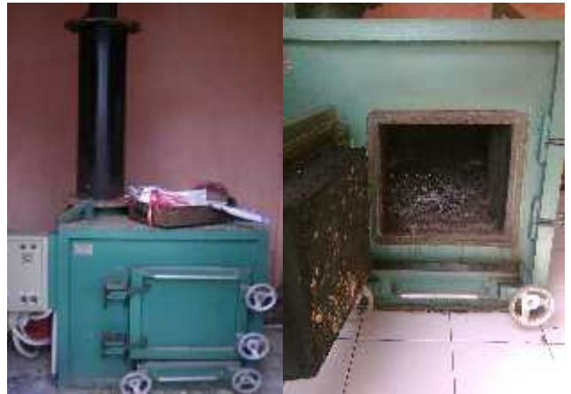
Gambar 22. Incinerator yang digunakan untuk memusnahkan sampah medis
