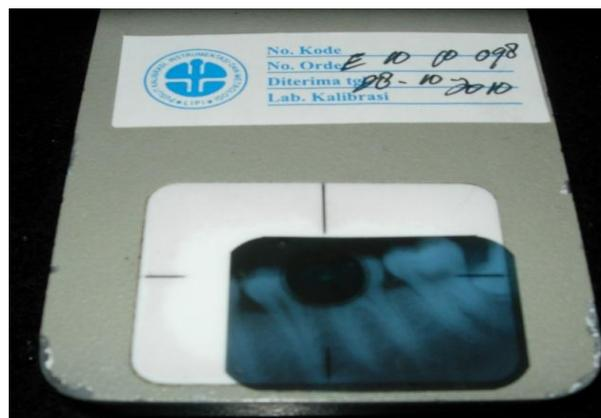
Gambar F.2 Pembacaan film radiografi pada meja panel densitometer
